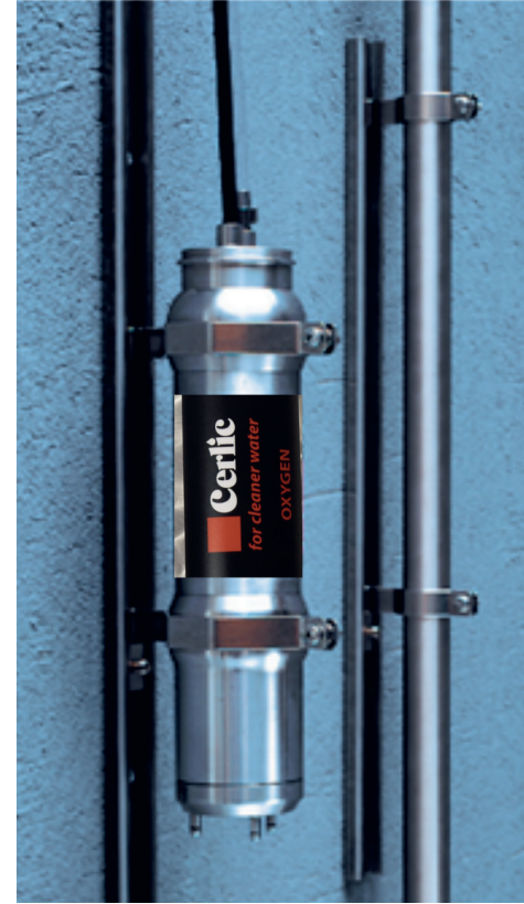
Montageschiene aus SS316 für einfache Installation und Wartung. Erhältlich in zwei Größen Ø20mm für pHX, ReX und FLX und Ø66mm für O2X und TSS-Sensoren. Die Schiene hat einen verstellbaren Anschlag, ist einfach zu installieren und leicht zugänglich für Reinigung und Adjustierung der Sensoren.
