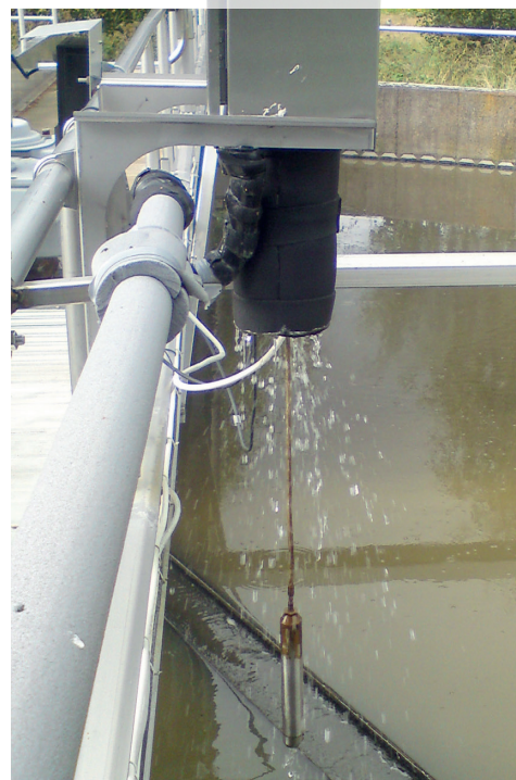
CBX är inbyggd i ett rostfritt apparatskåp för installation i varierande miljöer. Den har automatisk rensning av både givare och kabel efter varje lodning.
