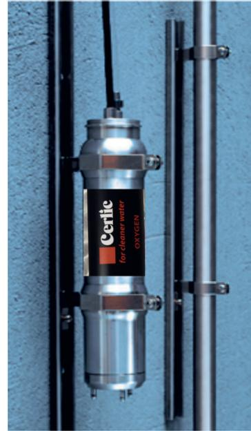
Rail de montage coulissant pour une installation et un entretien facile. Disponible en 2 tailles 28 mm Ø pour les sondes pHX, ReX et FLX et 66 mm Ø pour les sondes O2X et ITX. Les rails sont équipés d'une butée ajustable sur site. L'installation et la vérification des sondes est facile pour l'inspection, le nettoyage et le changement des capteurs.
