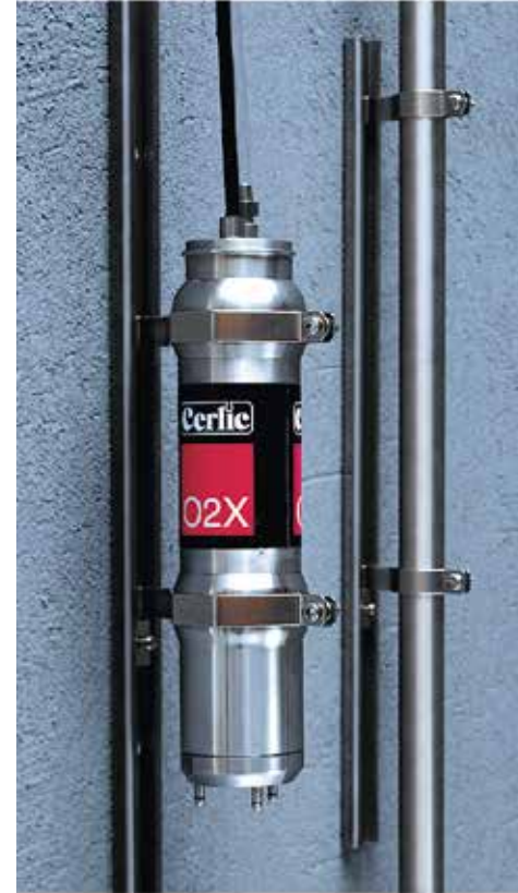
Montageschiene aus SS316 für einfache Installation und Wartung. Erhältlich in zwei Größen Ø20mm für pHX, ReX und FLX und Ø66mm für O2X und ITX-Sensoren. Die Schiene hat einen verstellbaren Anschlag, ist einfach zu installieren und leicht zugänglich für Reinigung und Adjustierung der Sensoren.
